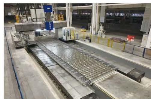
济南二机XK2750×240 数控定梁龙门移动镗铣床
