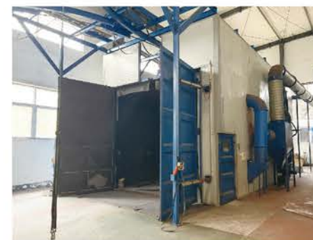
Q26YCCJ 全自动刮板回收式喷砂房
