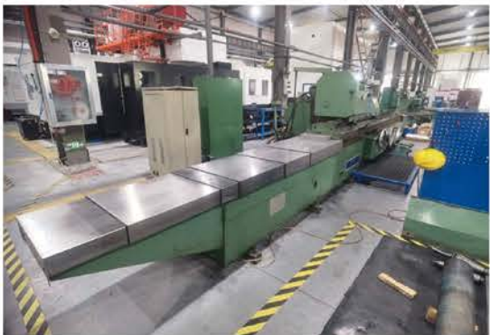
H309高精度万能外圆磨床
