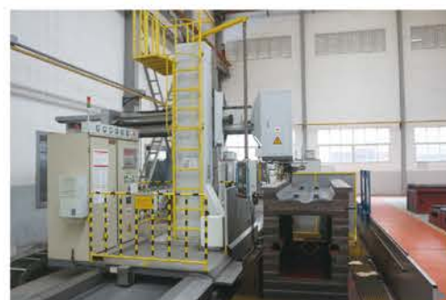
HKHC800CC 超音频数控卧式导轨淬火机床
