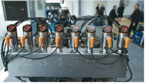
宜昌长机自制静压刀架体 测试平台
